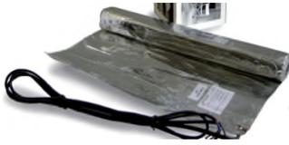
Dipolares Heiznetz mit Alubeschichtung zur trockenen Verlegung zwischen Trittschall und schwimmend verlegten Laminat, Parkett oder Vinyl.
