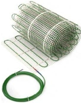
Muffenlose green electric mat **mit 2 Heizleistungen**. Speziell geeignet für den Anschluss an Photovoltaikanlagen und vorbereitet für neue Lademodelle. Millimeter-Heizmatte zur Einbettung in Ausgleichsmasse oder Flexkleber direkt unter dem Fussbodenbelag. Aufbauhöhe nur 4mm. Dipolar - mit nur einem Anschlusskabel.
