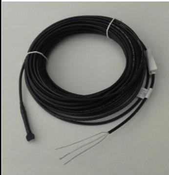
Heizschleife zur Einbettung in Ausgleichsmasse oder Flexkleber direkt unter dem Fussbodenbelag. Kabeldurchmesser nur 4mm. Auch geeignet für die Verlegung in ausgefräste Ausschnitte. Dipolar - mit nur einem Anschlusskabel. Höchste Sicherheit durch muffenlosen Übergang zum Anschlusskabel.
